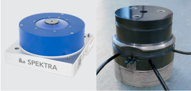
Schwingungserreger SE-29 (links) und dazugehörige Antriebsspule mit Keramikarmatur zur Befestigung der Prüflinge (rechts)
