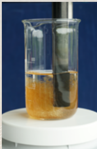
Konduktometrische Messung einer Gleichgewichtseinstellung
