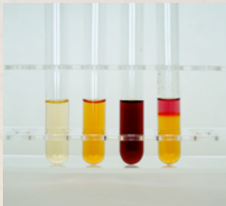
Komplexierungsgleichgewichte und unterschiedliche Löslichkeiten von Eisen-Thiocyanat-Komplexen
