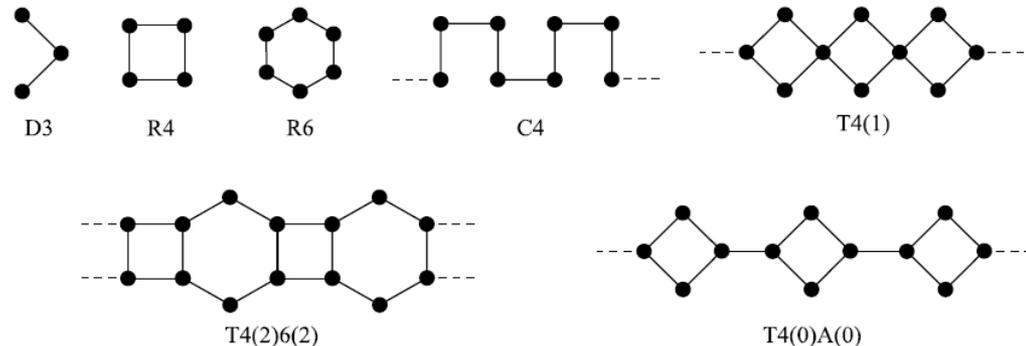
Punkte: Wassermoleküle, Striche: Wasserstoffbrückenbindungen
