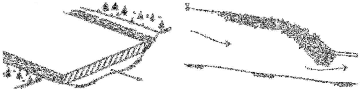
a) Dickenwachstum einer geschlossenen Eisdecke      b) Zusätzlich Abgleiten von Treibeis unter eine geschlossene Eisdecke
