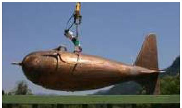
b) US-P61 Suspended-Sediment-Sampler (USA)
