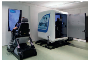
Baggersimulatoren für die Lehre (rechts: Kabinensimulator)
