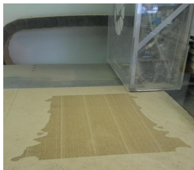
Druck des Kapitells mittels Binder Jetting
