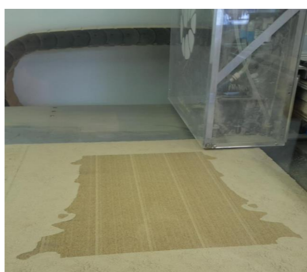
Druck des Kapitells mittels Binder Jetting
