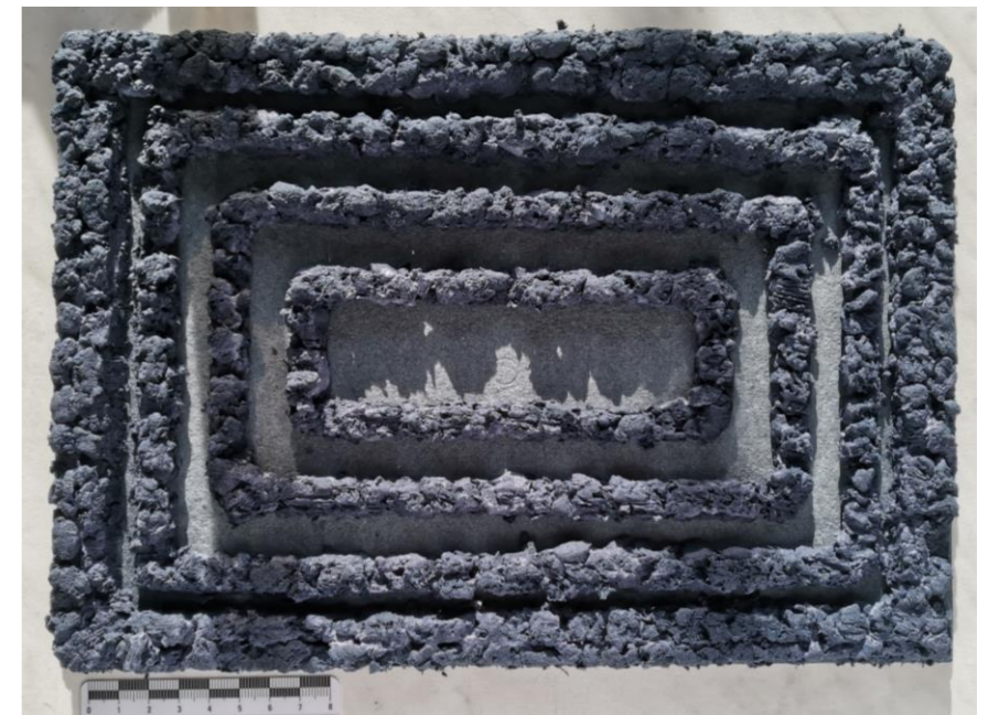
Prototyp in der Fertigung: gedrucktes Infill auf der Faserplatte
