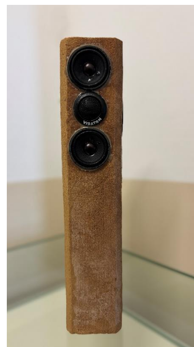
Lautsprechergehäuse mittels additiver Fertigung aus Holz hergestellt. Form entspricht noch „klassischem design“, um akustische Eigenschaften mit einem Aufbau aus Holzplatten zu vergleichen.
