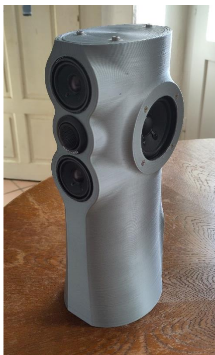
Beispiel: Additiv gefertigter Lautsprecher aus Kunststoff mit komplexem Design (konventionell aus Holz schwer herstellbar)
