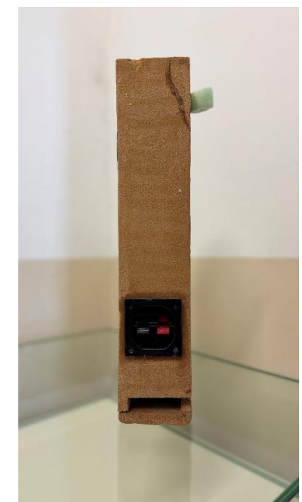
Lautsprechergehäuse mittels additiver Fertigung aus Holz hergestellt. Form entspricht noch „klassischem design“, um akustische Eigenschaften mit einem Aufbau aus Holzplatten zu vergleichen.
